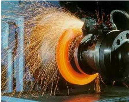
Figura 17 - Ensaio de freio a disco em dinamômetro inercial.
