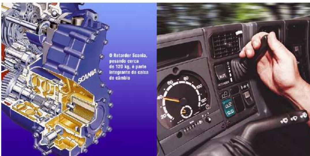
Figura 103 - Retarder hidráulico Scania®
