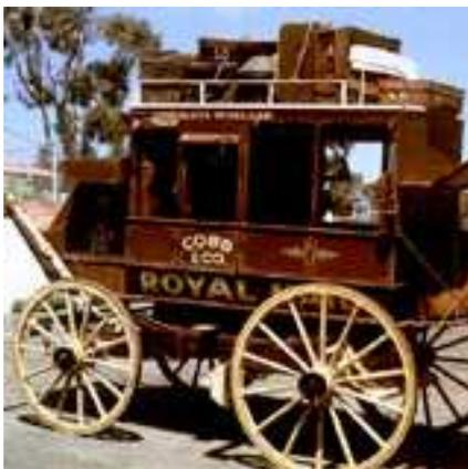
Figura 6 - Os primeiros freios de serviço e estacionamento (sapatas de madeira).
