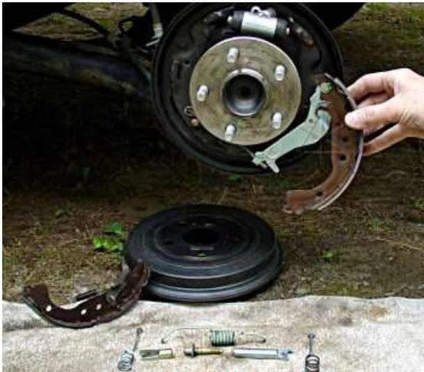
Figura 31 - Esquema de acionamento do freio de estacionamento
