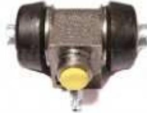
Figura 27 - Cilindro de roda
