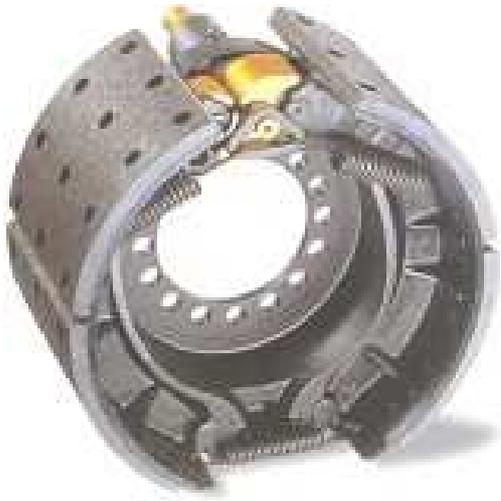
**Freio Simplex e Duo Duplex Tipo Wedge (atuação hidráulica e pneumática)**
