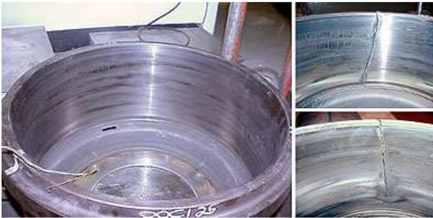
Figura 74 - Tambores com stress térmico e mecânico
