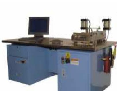
Figura 128 - Máquina de cisalhamento (by Link®)
