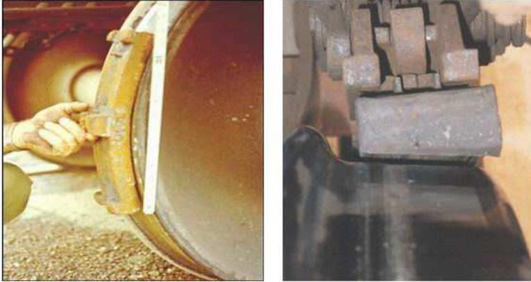
Figura 64 C - Exemplo de montagem de sapata ferroviária
