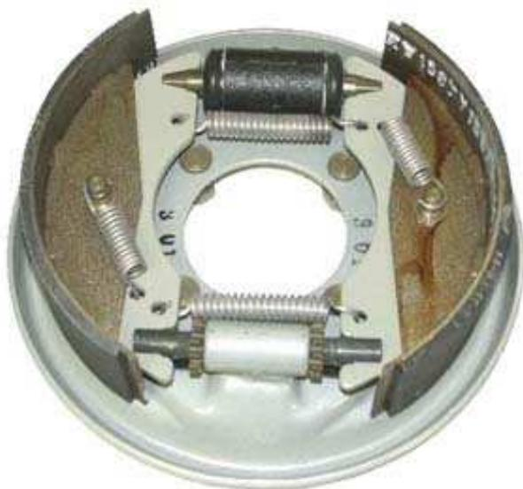
Figura 40 - Freio Duo-Servo atuado hidraulicamente
