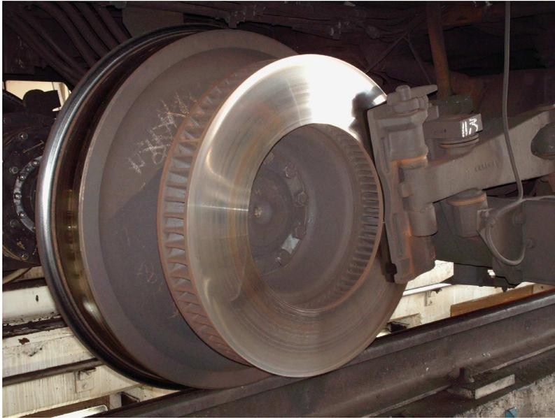
Figura 64 A - Freio a Disco utilizado no Metrô SP
