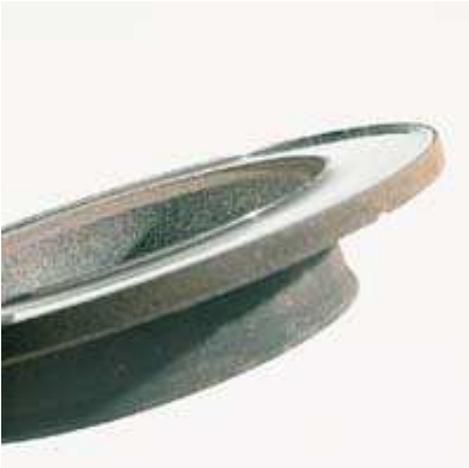
← Disco com desgaste excessivo
