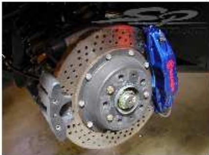
Freios a disco de alta performance, como o nome já designa, foram especialmente desenvolvidos para veículos esportivos, que necessitam de grandes taxas de desaceleração em função das velocidades atingidas, alta resistência a temperatura, e principalmente estabilidade de frenagem em condições extremas.
