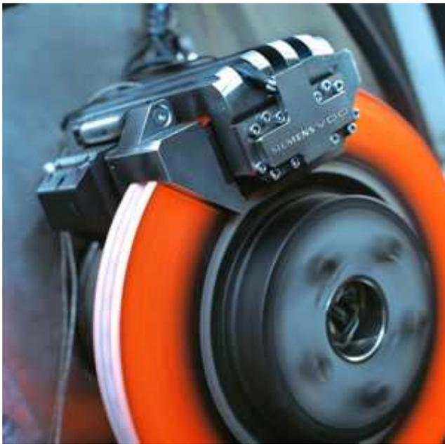
Figura 113 C - Freio EWB® sendo avaliado em dinamômetro inercial
